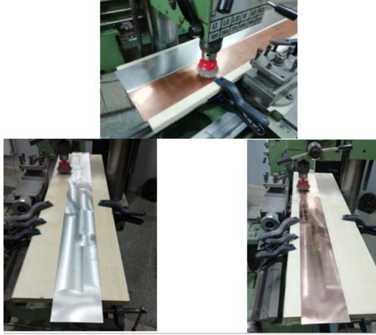
Şekil 1. Al ve Cu levhaların yüzey polisaj işleminin yapılması
