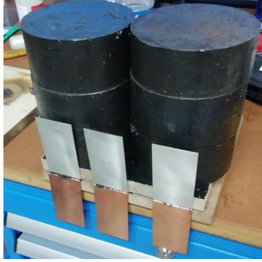
Şekil 5. Çekme ve soyulma test numunelerini yapıştırılması ve kurumaya bırakılması
