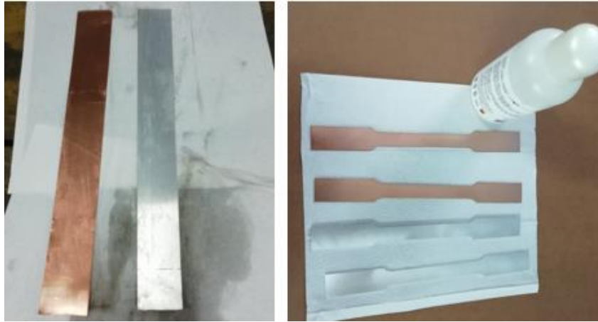
Şekil 4. Çekme ve soyulma test numunelerinin aseton ile temizlenmesi
