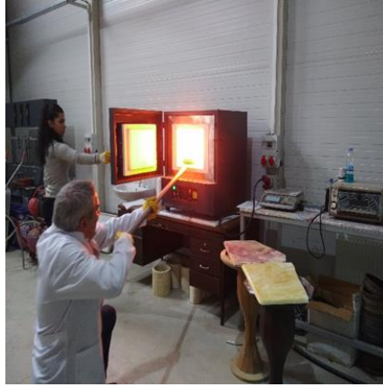
Şekil 8. Levhaların şoklama yöntemi ile fırında pişirilmesinin ardından çıkarılması
