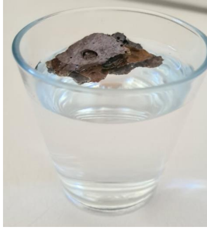
Şekil 5. Genleşmiş kil numunesinin suda batma testi
