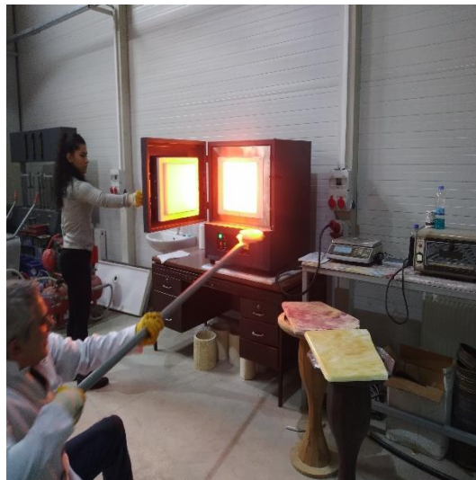
Şekil 3. Yüksek sıcaklıktaki fırına deney numunelerinin yerleştirilmesi
