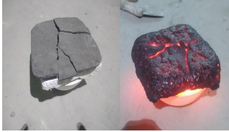
Şekil 6. Kopan parçaların ısıtılma sonrası kaynaşarak bağlanması (sinterleşme etkisi)
